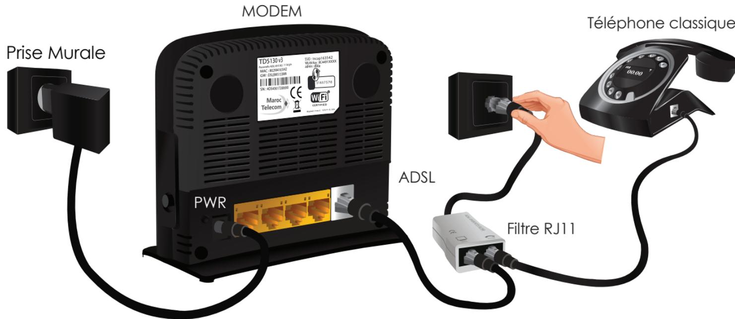
Si votre habitation est équipée d'une prise réseau murale RJ11, branchez la prise téléphonique murale au port phone du filtre RJ11 et le câble DSL au « port modem » du filtre RJ11.
