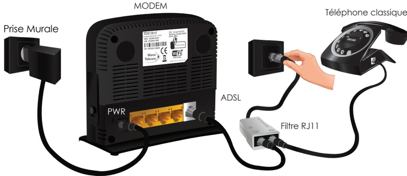
Schéma de branchement avec Filtre RJ11
