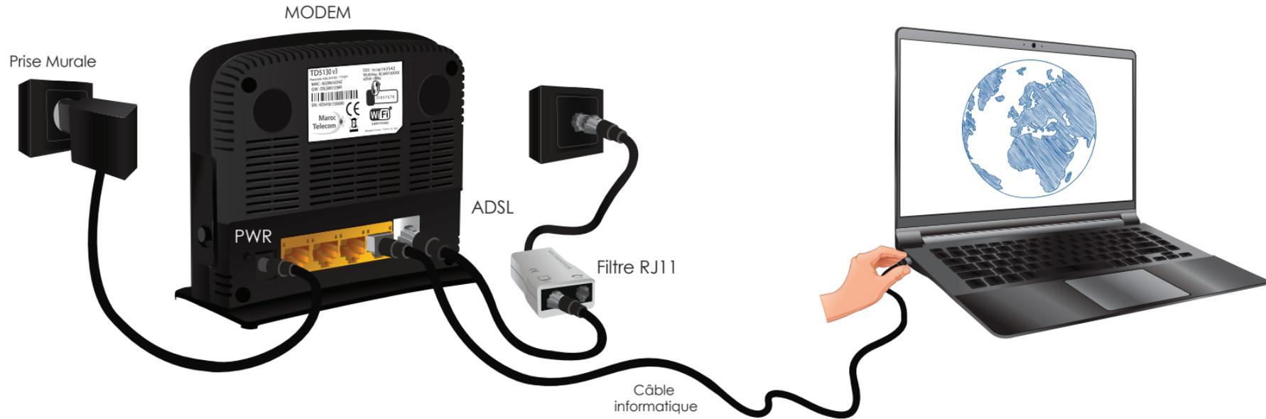
Introduire une extrémité du câble Réseau à un des ports Ethernet du routeur. Ensuite branchez l'autre extrémité du câble à votre ordinateur.
