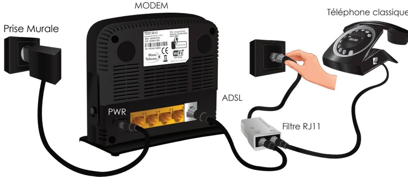
Schéma de branchement avec Filtre RJ11
